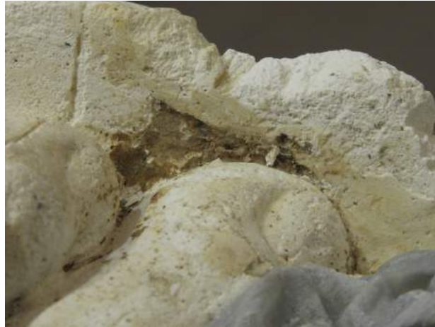
Restos de arcilla debajo de repasos realizados con una escayola más anaranjada.
