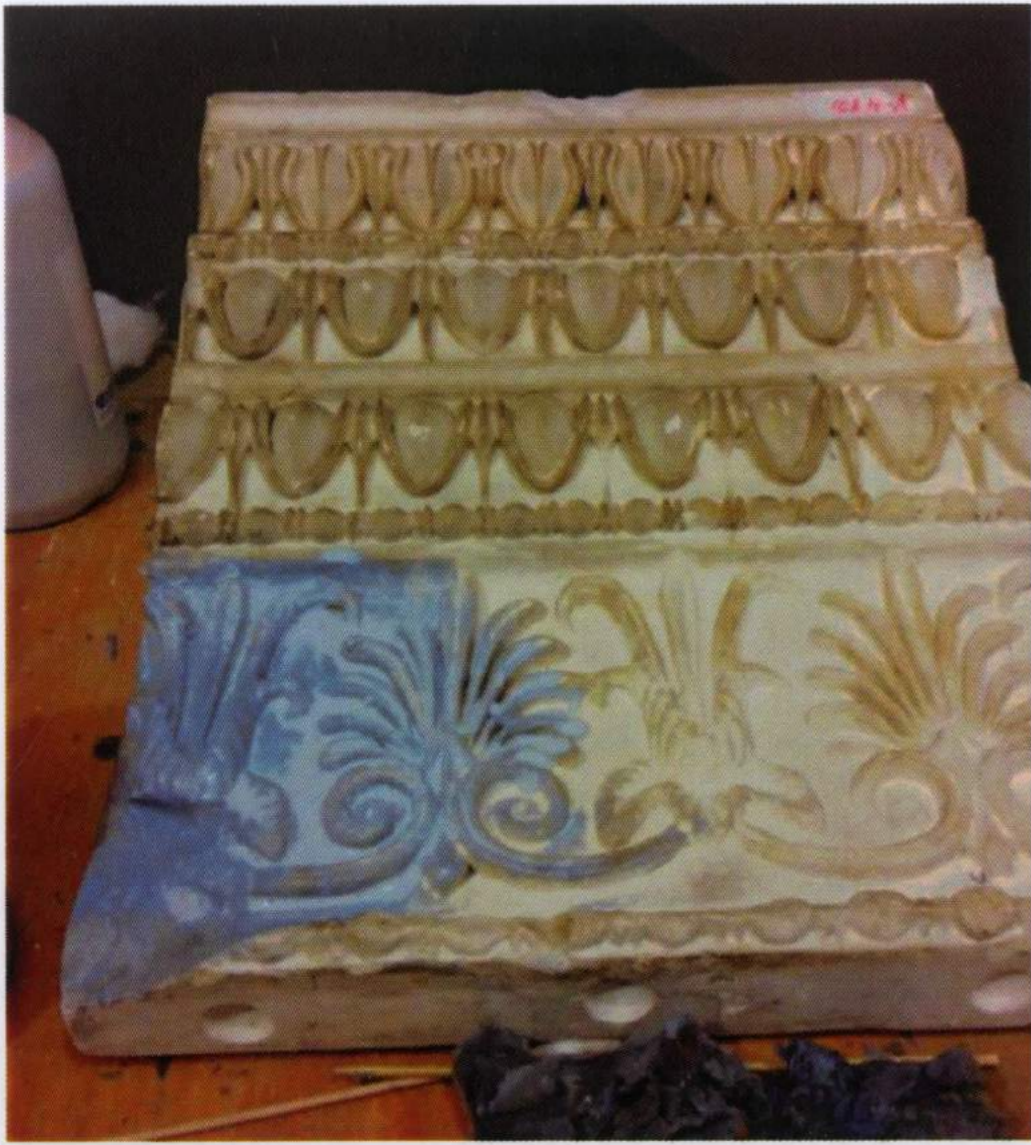
Eliminación del Anjusil® una vez seco y resultado de la limpieza.
