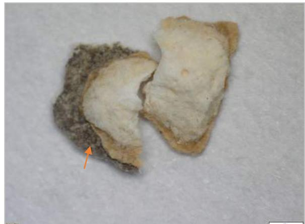
Figura 8.- Fotografía obtenida mediante ME (1,25x) del reverso (capas más internas) de la micromuestra A. En esta imagen se puede apreciar el color pardo-grisáceo y el aspecto cristalino de la capa 5 (ver tabla 2).
