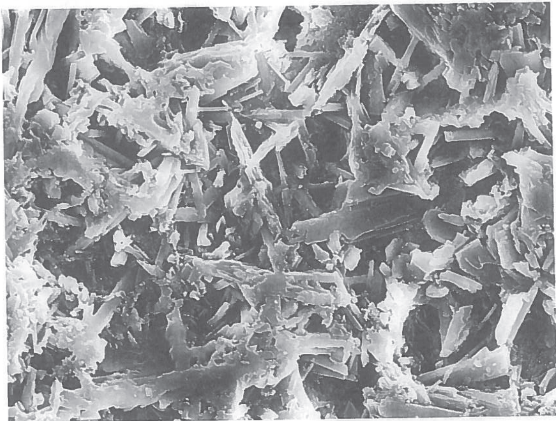
Fig 4: Bacco Médici - Capa superficial rotura brazo a 2000 aumentos.
