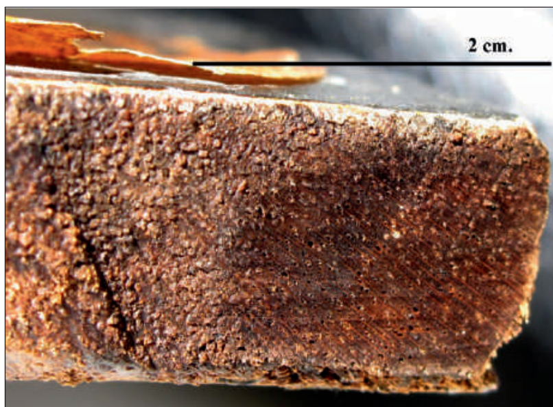
Fig. 29. Autorretrato . Detalle del borde inferior, esquina derecha, donde se tomó la muestra de madera para el corte transversal .
