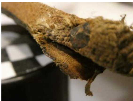
Tela original y la usada en el reentelado (21) 759, medición de la original con micrómetro
