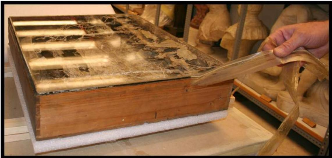
Fotografía N° 44. Eliminación de la cinta adhesiva.
