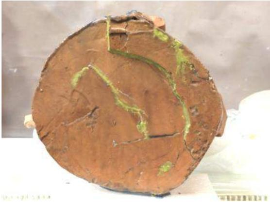
Cara de contacto impermeabilizada con látex y fisuras rellenas con plastilina para evitar que la escayola se pegue y se enganche.
