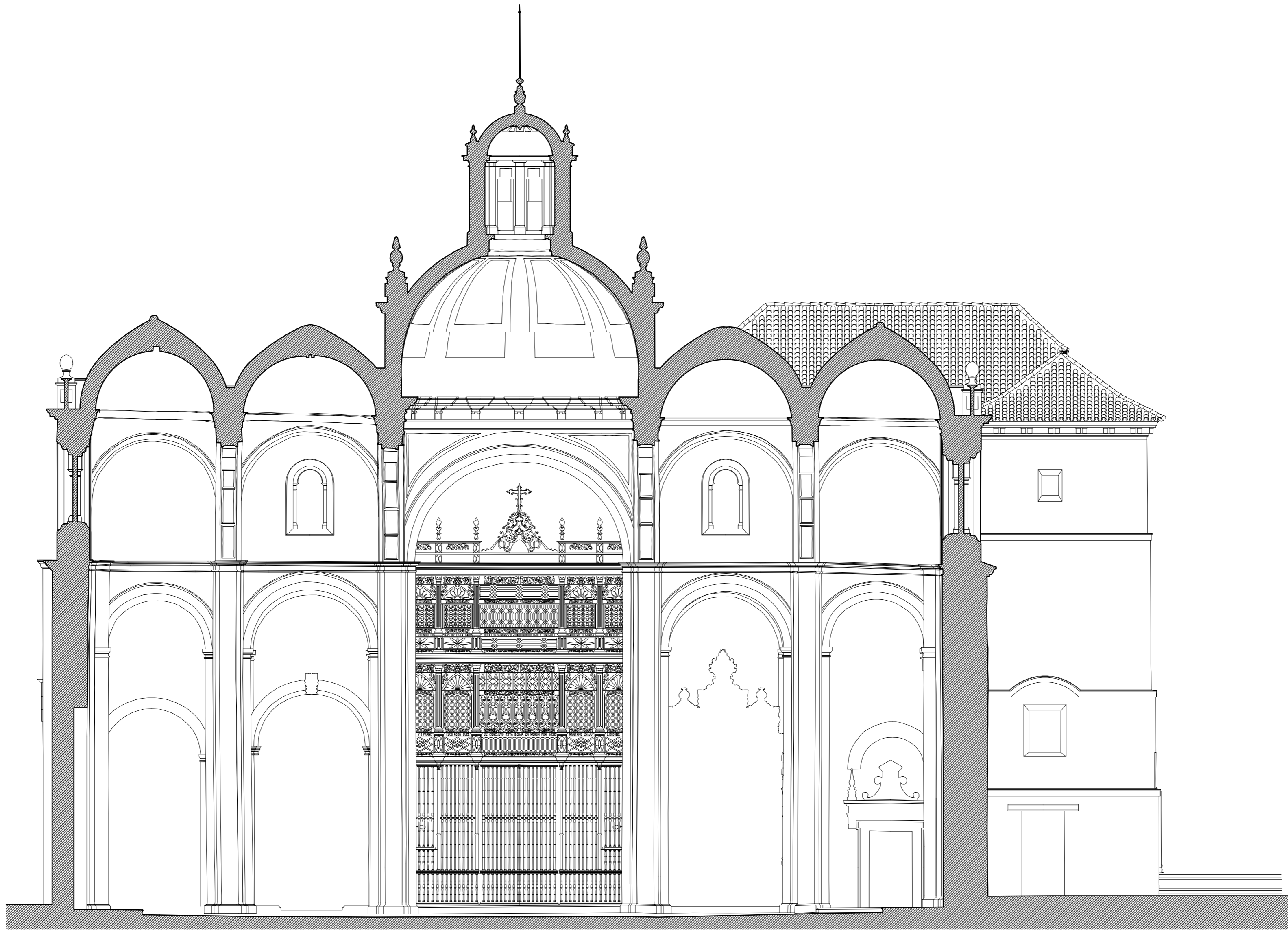
IGLESIA PARROQUIAL DE SAN MIGUEL. SECCION TRASVERSAL EN NAVE CRUCERO. MORON DE LA FRONTERA (SEVILLA).
