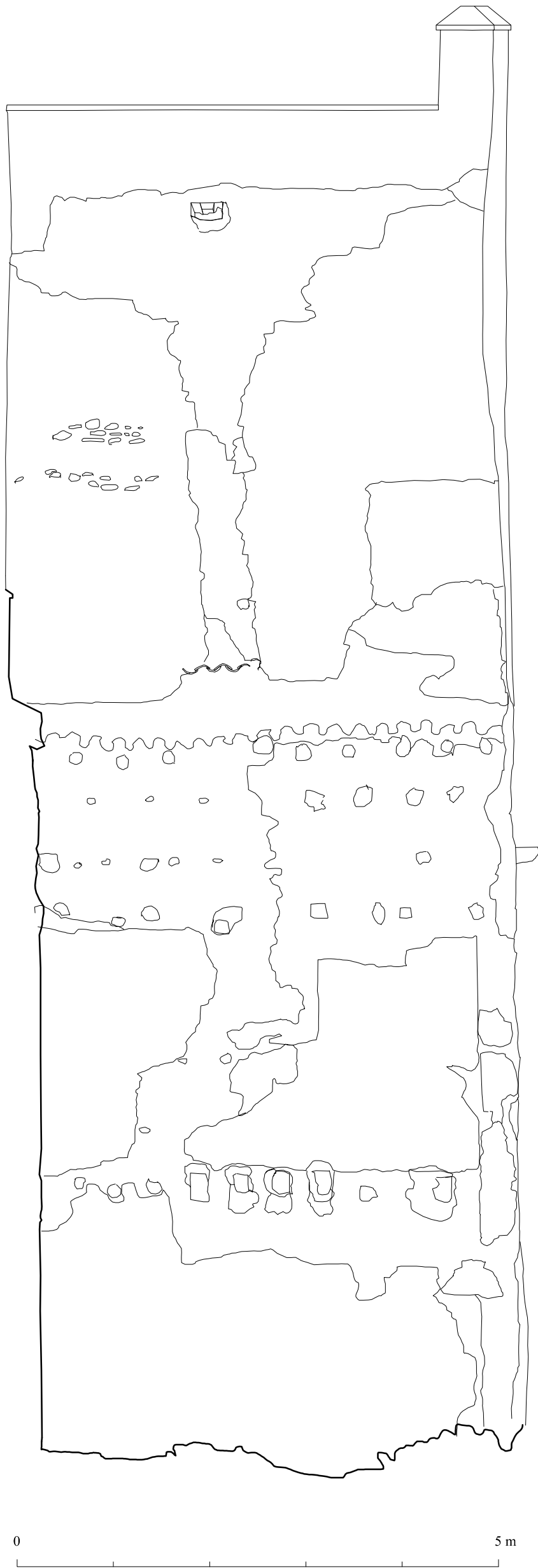
PUERTA DE ELVIRA. GRANADA. Estado inicial Escuela de Estudios Arabes. CSIC. A. Almagro / arq. A. Orihuela / arq.
