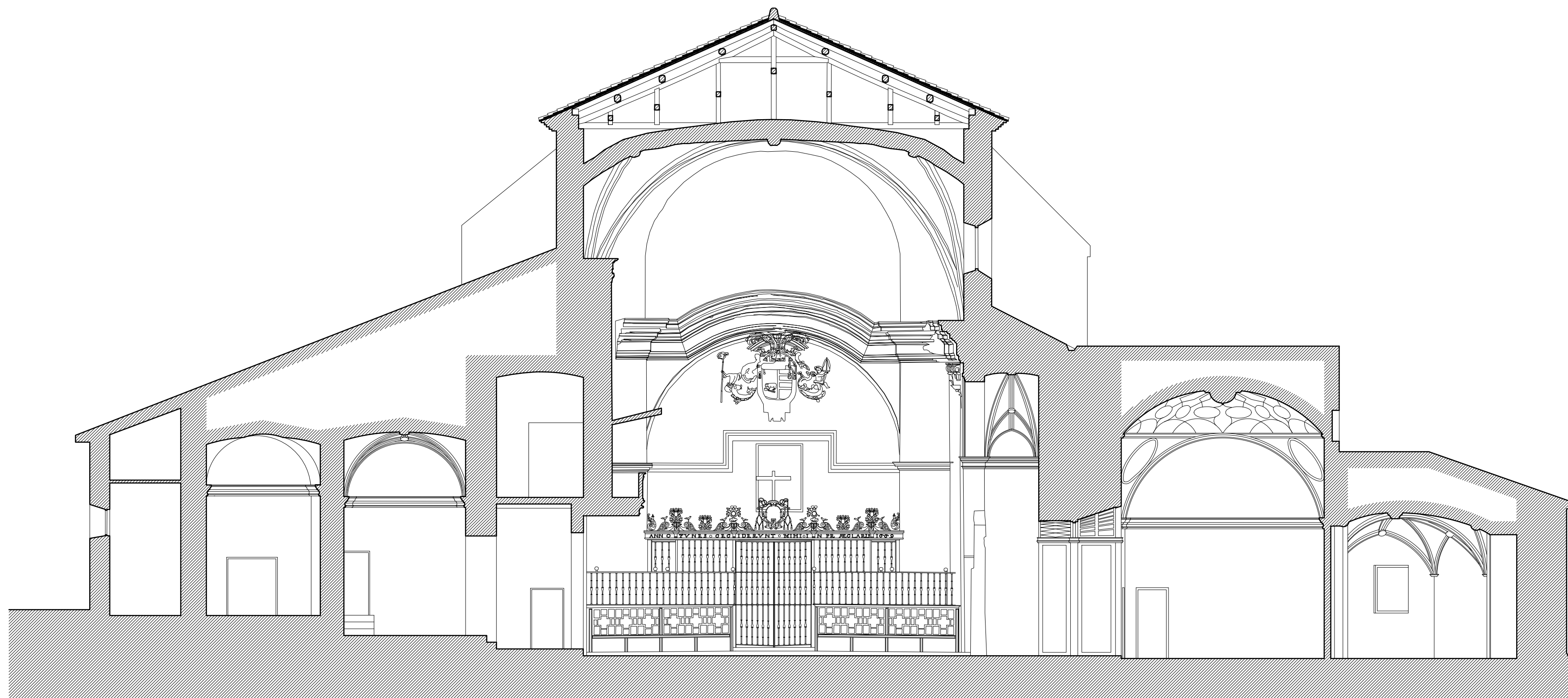
CATEDRAL DE ALBARRACIN. SECCION TRANSVERSAL POR EL ORGANO
