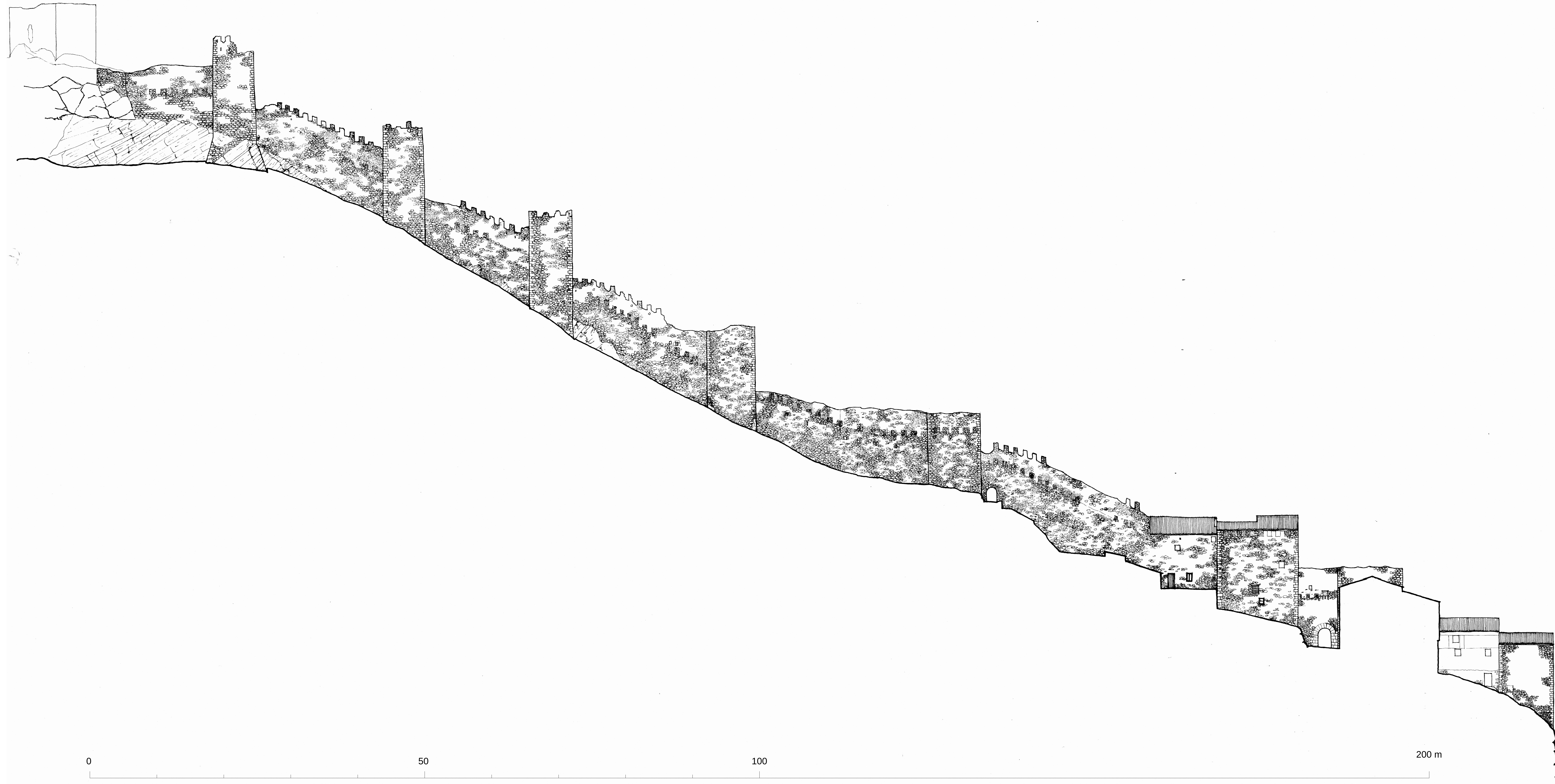
ALBARRACIN RECINTO EXTERIOR ESTADO ACTUAL ALZADO OESTE
